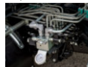
Centralina idraulica comprensiva di sistema di "spalmatura" Main directional control valve of dynamic pressure scraper system
